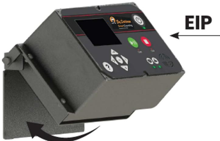
4. Branchez la caméra et le câble Internet dans les ports correspondants de l'unité EIP. Branchez le câble électrique sur une prise de courant avec terre.
